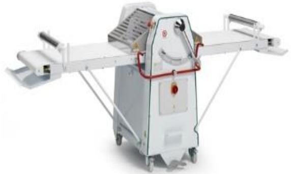
**Descripción general:** La laminadora sirve para extender masas de hojaldradas, pastas, mazapanes o similares dándoles el grosor deseado. Mientras los rodillos graduables en anchura y grosor quedan fijos, la masa es la que se desplaza. Consta de un cuerpo central (donde va incorporado el motor y los rodillos) y dos alas (una por banda) con banda móviles.
