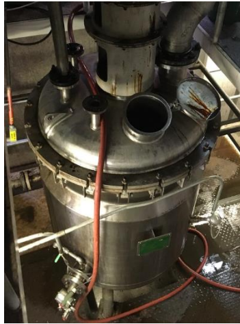
Figura 8. Tanque reactor de miel natural
