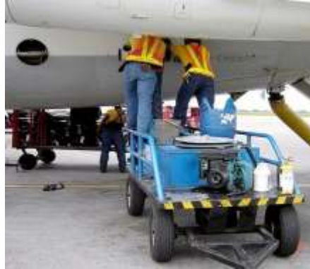
Foto 9. Conexión del equipo para la evacuación de residuos sólidos y líquidos
