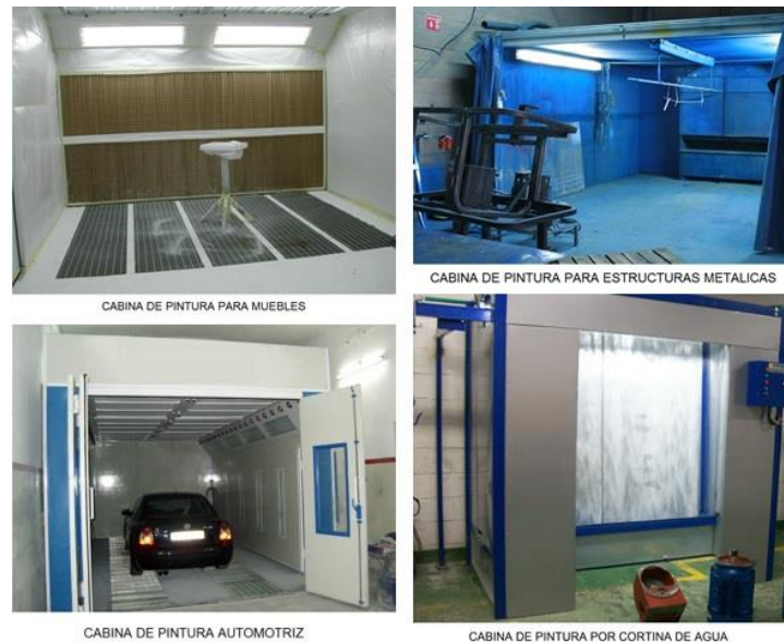
Figura 31. Diferentes tipos de cabinas de pintura
