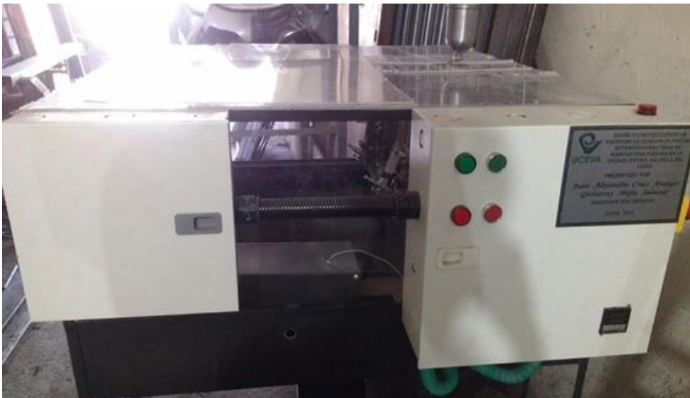
Figura 78 Tanque de pintura, tablero eléctrico y de control del prototipo.
