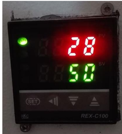
Figura 75. Pantalla de configuración sistema de control temperatura.
