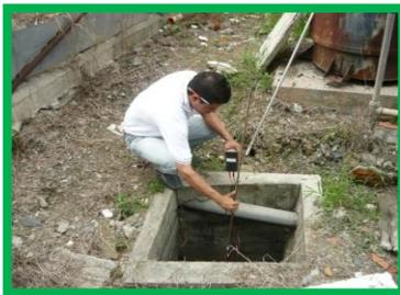
**Fotografía 25. Aforo método volumétrico**
