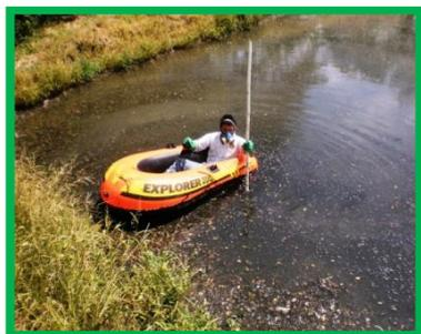
Fotografía 15. Medición de lodos
