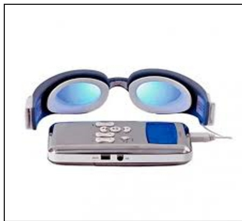
Ilustración 2. Equipo LAXMAN de estimulación audio-visual
